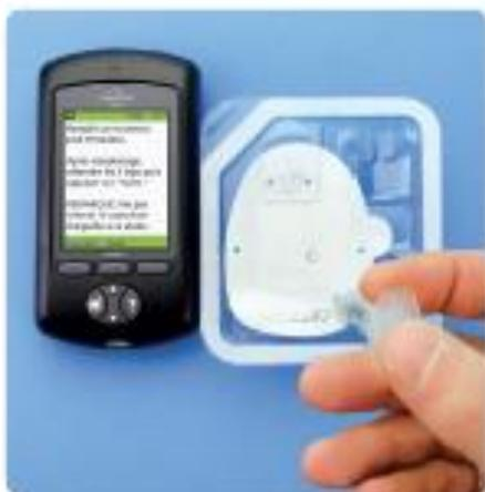
**Pour assurer une bonne communication entre le Pod et le GPD, remettez le Pod dans le plateau d'emballage original et placez-le à la droite du GPD, de façon à ce qu'ils se touchent.**
